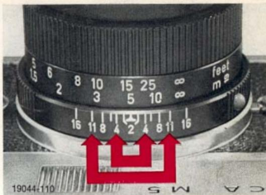
Si par exemple vous avez réglé l'objectif SUMMICRON® 1:2/50 mm sur la distance de 5 m, la profondeur de champ s'étend de 4 m à environ 8 m au diaphragme 4. Par contre, au diaphragme 11, la profondeur de champ va de 3 m à environ 20 m, pour la même distance de mise au point.
