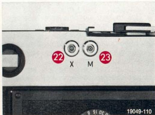
Les flashes et adaptateurs sans câble de connexion sont déclenchés par le contact "X" de glissière porte-accessoire (5).
