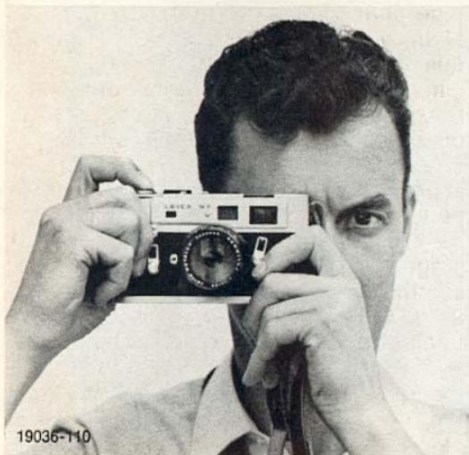
La tenue en trois points, la meilleure façon de tenir l'appareil, consiste à le saisir avec la main droite, l'index étant posé sur le bouton de déclenchement et le pouce sur le levier d'armement. La main gauche ou bien soutient l'objectif par-dessous, prête à effectuer rapidement la mise au point, ou bien saisit l'appareil. Le troisième point est fourni
