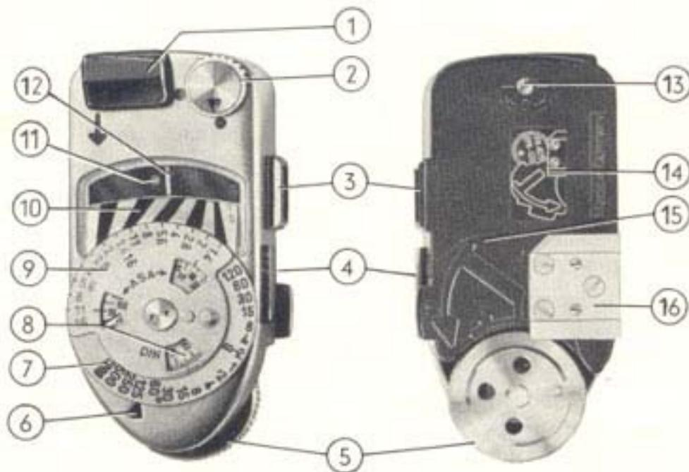
1. **Bouton de mesure.** En appuyant sur ce bouton dans le sens de la flèche, vous libérez l'aiguille pour effectuer la mesure. Dès que vous lâchez le bouton, l'aiguille reste immobilisée sur la valeur trouvée. Il suffit d'appuyer pendant deux secondes environ sur ce bouton pour faire la mesure.
