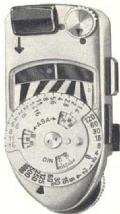
Pour les temps de pose dépassant 1 seconde, il faut désaccoupler le bouton moleté (5) en le réglant sur «B» et en le soulevant, puis en continuant à le tourner comme pour enlever le posemètre de l'appareil (voir page 8). Vous pouvez alors lire les temps de pose dépassant 1 seconde sur le posemètre.
