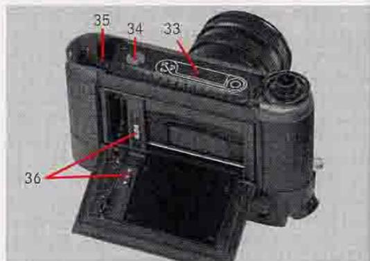
**Remarque:** Lorsque le dos est rabattu, les trois contacts (36) du dos et du boîtier de l'appareil sont visibles. Ces contacts sont protégés contre la corrosion par dorure et sont donc peu sensibles aux salissures. Ils ne nécessitent par conséquent aucun entretien particulier. Lors du changement du film, veillez toutefois à éviter tout dépôt de poussières ou salissures ou la pénétration directe d'eau (gouttes de pluie etc.).
