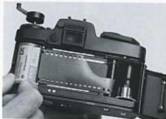
Placer alors la cartouche dans le logement vide. Pour cela relever complètement la manivelle. Repousser la manivelle quand la cartouche est en place. Le bord du film doit être parallèle aux rails de guidage et les dents du pignon doivent pénétrer dans les perforations quand on actionne le levier d'armement.
