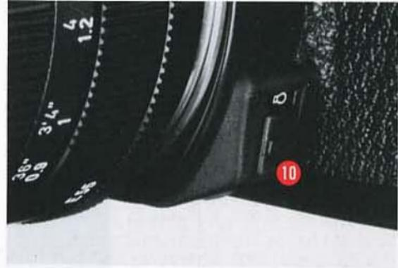
commutateurs aura été relâché, l'éclairage restera encore allumé pendant environ 12 secondes avant de s'éteindre automatiquement, à condition que l'obturateur soit armé. L'éclairage d'appoint peut aussi être commuté en «B». Pour économiser le courant des piles, il faut éviter de brancher inutilement cet éclairage.
