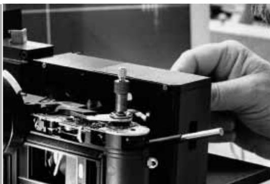
Ajustage du système de mesure télémétrique
