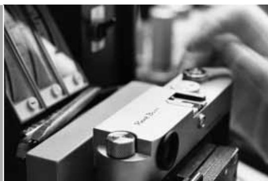
Contrôle final des vitesses d'obturation
