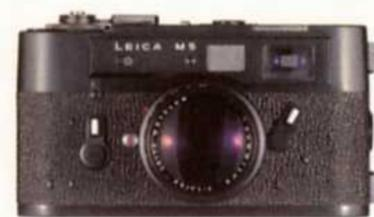
**1971** Le LEICA M5 est le premier M à être équipé de la mesure de l'exposition à travers l'objectif. Comme autres nouveautés, mentionnons aussi la surface chromée noire, l'exposition jusqu'à 30 secondes, le grand barillet de réglage du temps de pose et le contact central pour flashes.
