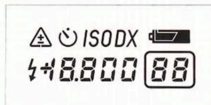
Sur l'affichage LCD au dos de l'appareil on peut contrôler si le flash est prêt à fonctionner ainsi que d'éventuelles corrections d'exposition.
